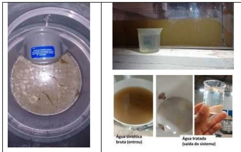
Figura 6 – Água bruta na caixa de gordura, água no decantador com sedimentos ao fundo e Becker com a água resultante do sistema. Fonte: fotos dos autores.
